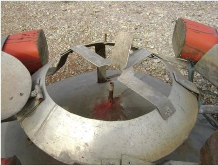
FIGURA 4.19: Detalhe do tubo de passagem do gás montado no coletor de gás.
