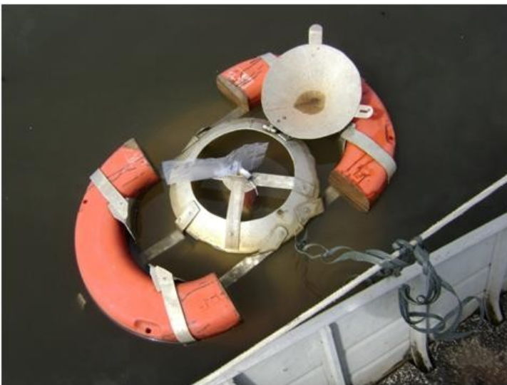
FIGURA 4.20: Posicionamento do coletor de gás, com o “bag”acoplado para início de amostragem.
