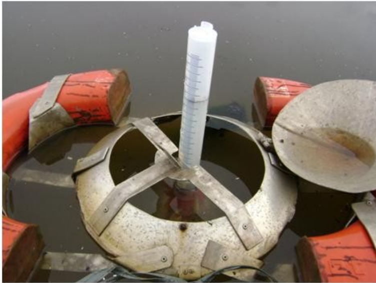
FIGURA 4.21: Medição das variáveis tempo e volume para auxílio no cálculo do fluxo de biogás.
