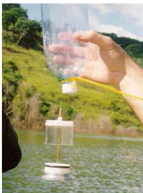
FIGURA 5.3: Câmaras de difusão acopladas a bóias.
