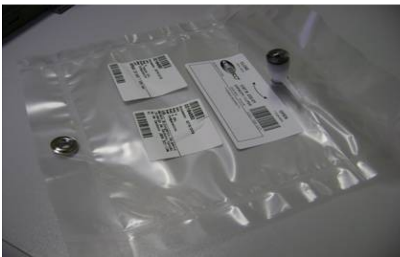
FIGURA 4.17: “Bag” para armazenamento das amostras de gás.
