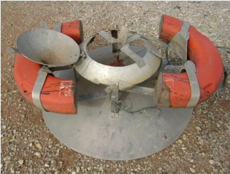
FIGURA 4.18: Coletor de biogás.
