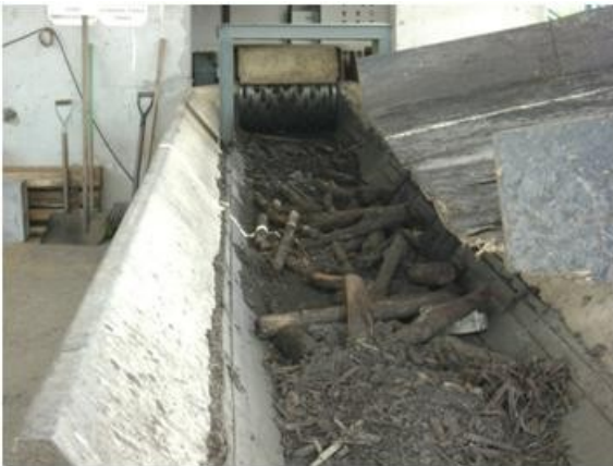
FIGURA 4.12: Picador de madeira, utilizado para picar poda de árvores ou casca de eucalipto.
