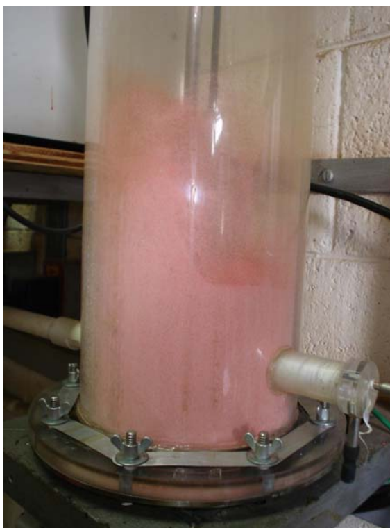
Figura 4.5 – Processo de recobrimento em Leito Fluidizado Pulsado-Rotativo (LFPR)
