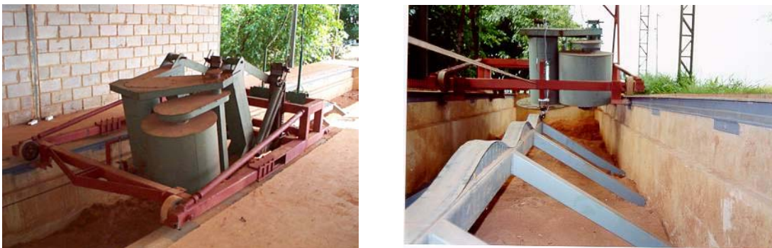
Figura 22: Vistas do cortador basal montado no carro porta ferramentas da caixa de solo.
