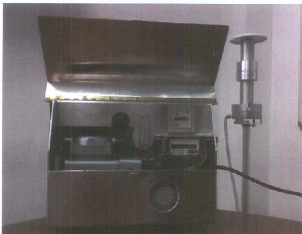
Figura 2: Gabinete metálico com componentes montados e impactador no tripé
