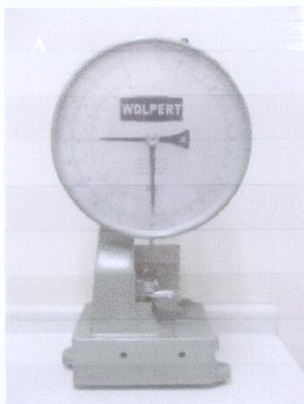
Figura A e B – Teste de impacto sistema Charpy.
