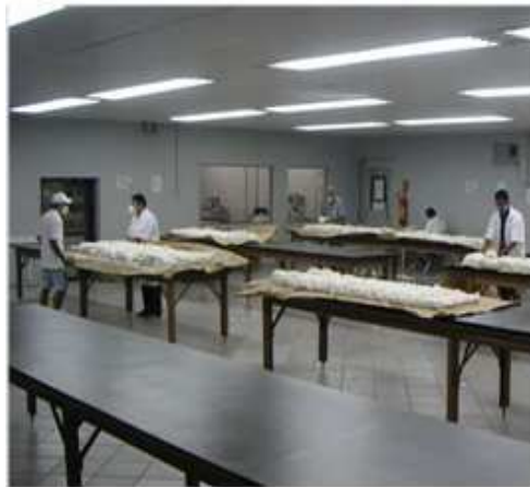
Figura 4 – Análise e Classificação da Fibra do Algodão – Método Visual
