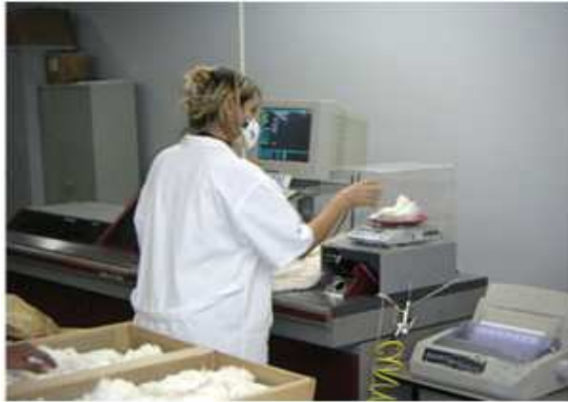
Figura 5 – Análise e Classificação da Fibra do Algodão – Método HVI
