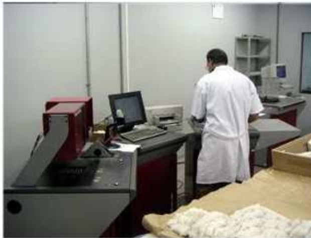
Figura 6 – Análise e Classificação da Fibra do Algodão – Método HVI
