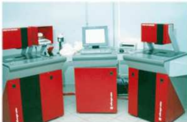
Figura 7 – Equipamentos HVI de Análise da Fibra do Algodão
