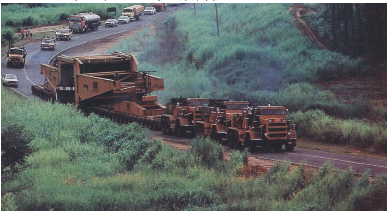
Figura 11 - TRANSPORTE RODOVIÁRIO DA TURBINA Nº 1 PARA O CANTEIRO DE OBRAS DE ITAIPU – NOV/1981
