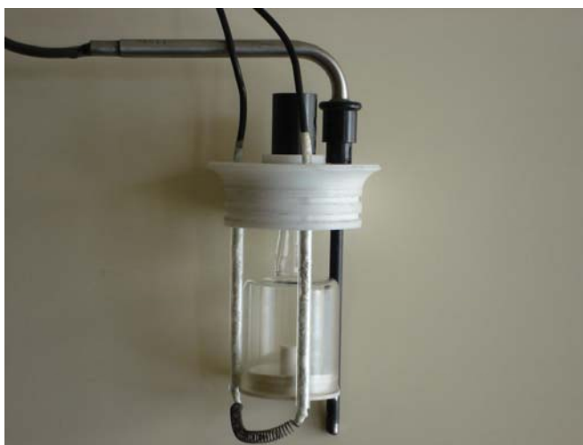
Figura 4.5 – Tampa de teflon do vaso Dewar. Nesta tampa se encontram inseridos a célula de vidro, o termistor e a resistência elétrica.
