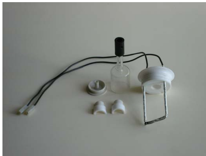
Figura 4.3 – Itens necessários para a montagem da célula de vidro na tampa do vaso Dewar.
