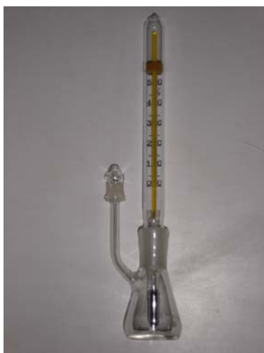
Figura 4.6 – Picnômetro de 5,0 cm 3 com termômetro e tampa.
