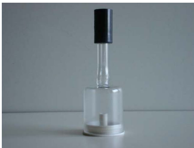
Figura 4.4 – Célula de vidro com disco de Teflon.
