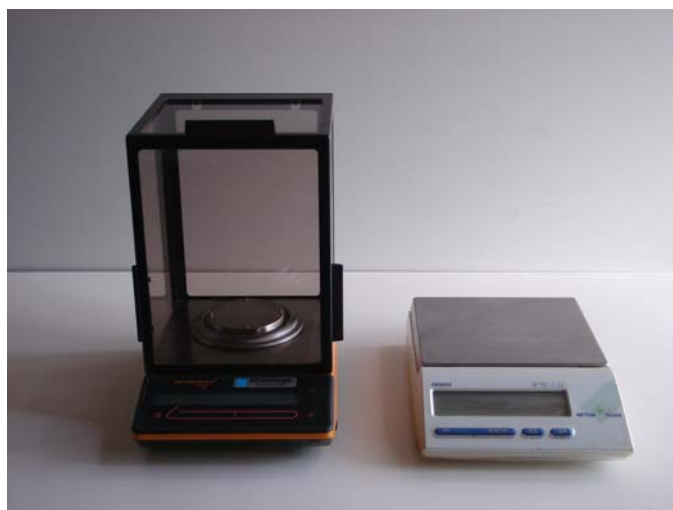
Figura 4.2 – Balanças utilizadas para o preparo das soluções. Sartorius MC210P (precisão, \pm 10^{-4} g) e Mettler Toledo PB 3002 (precisão, \pm 10^{-2} g).
