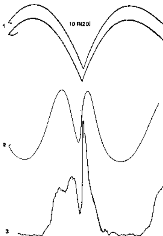
FIGURA ( 55 ) - ESPECTRO DE ABSORÇÃO FOTOACÚSTICO PARA ^{13}\text{CH}_3\text{OH} ; 1- CURVA DE GANHO DO \text{CO}_2 SINTONIZADO NA 10R(20); ESPECTROS DE ABSORÇÃO FOTOACÚSTICO 2- ALARGADO DOPPLER; 3- RESOLUÇÃO SUBDOPPLER.
