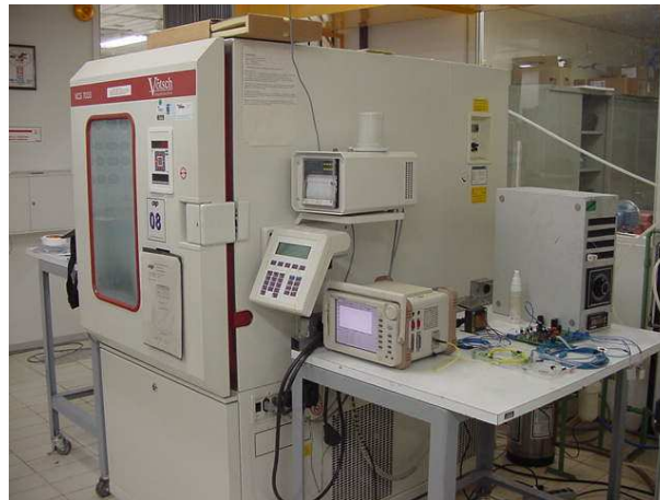
Fig. 6.8: Ensaio na câmara climática.
