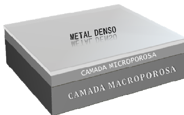
FIGURA 2.5 – Exemplo de membrana composta permeável.
