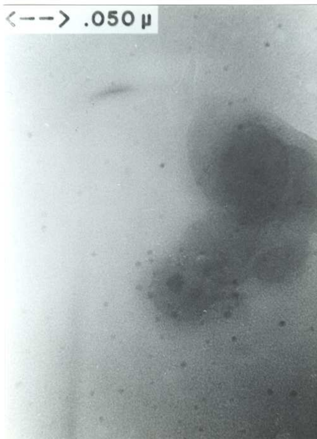
Figura 2.15: Microscopia Eletrônica por Transmissão em um vidro borossilicato dopado na proporção CdT_{e_{0.9}}S_{0.1} , mostrando a presença de nanoestruturas, obtidas através de tratamento térmico de 580^{\circ}\text{C} durante 40 minutos
