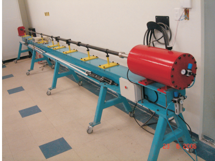
Figura 4.5: Barra de Hopkinson construída pelo GMSIE e utilizada nos testes de caracterização dinâmica dos materiais.
