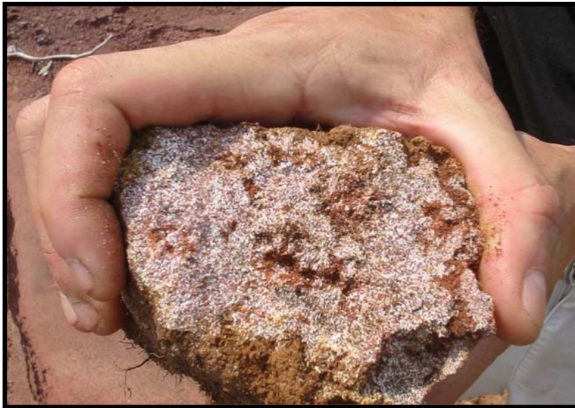
Figura 3. Detalhe dos grãos de zeólita contidos na amostra
