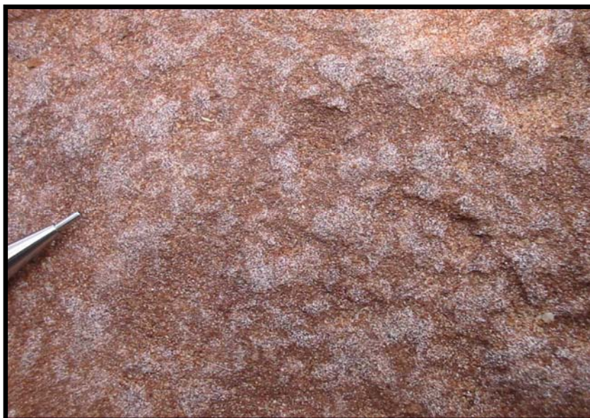
Figura 2. Arenito do qual foi extraída a amostra contendo zeólita (pontos brancos)
