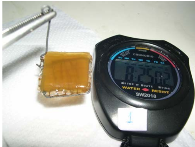
Aspecto do laminado B-P10 após 8 minutos imerso em xileno
