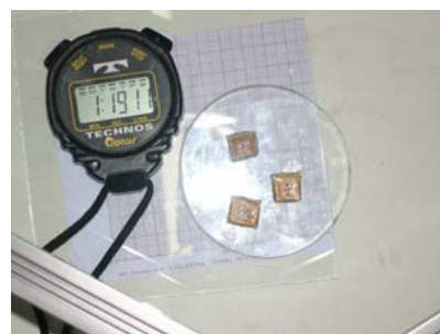
Laminado imerso em xileno e medidas de área das amostras após o ganho de massa.
