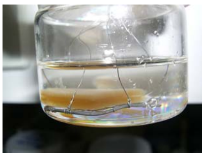
Laminado imerso em xileno e medidas de área das amostras após o ganho de massa.
