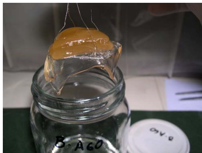
Aspecto do laminado B-P10 após 24 horas imerso em xileno
