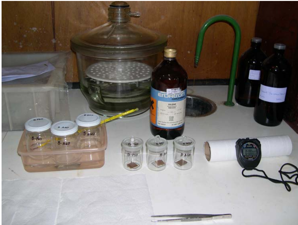
Foto mostrando o esquema utilizado para a realização do ensaio de intumescimento dos laminados auto-adesivos
