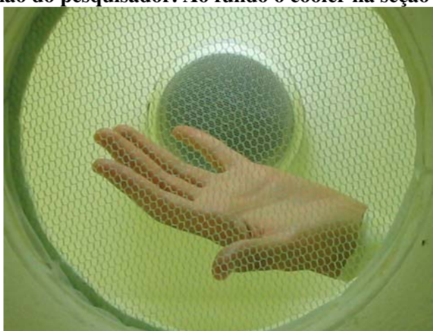
Figura 16 – Vista da Câmara K&L-Unicamp a partir do tubo, mostrando uma das telas avaliada e a mão do pesquisador. Ao fundo o cooler na seção C.
