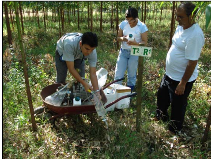
Figura 4.21 - Coleta do percolado armazenado no coletor de drenagem livre (Fonte: AUTOR, 2008)
