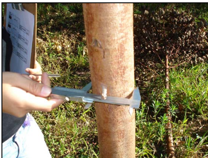
Figura 4.20 - Medição do DAP do caule do eucalipto (Fonte: AUTOR, 2008)
