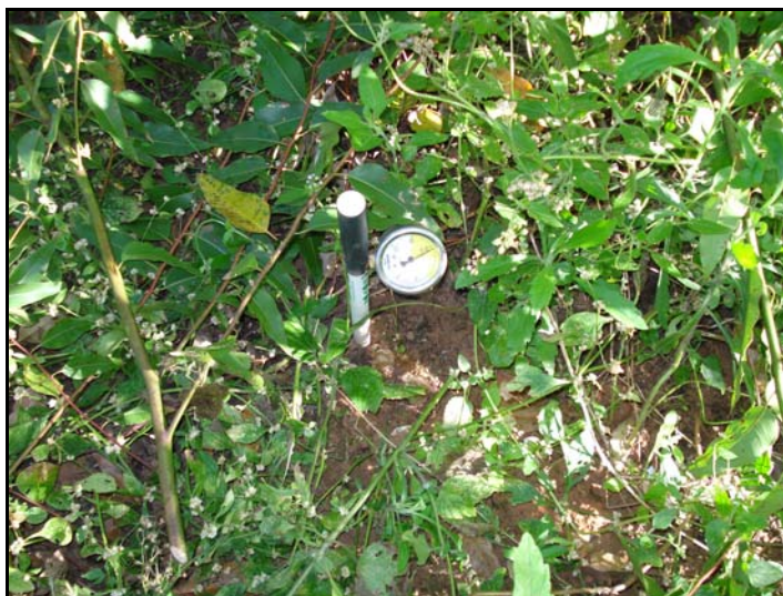
Figura 4.17 - Tensiômetro instalado na área experimental (Fonte: AUTOR, 2008)
