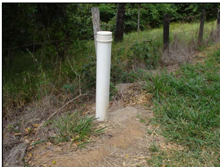
Figura 4.9 - Poço de monitoramento de água subterrânea instalado no experimento (Fonte: AUTOR, 2007)
