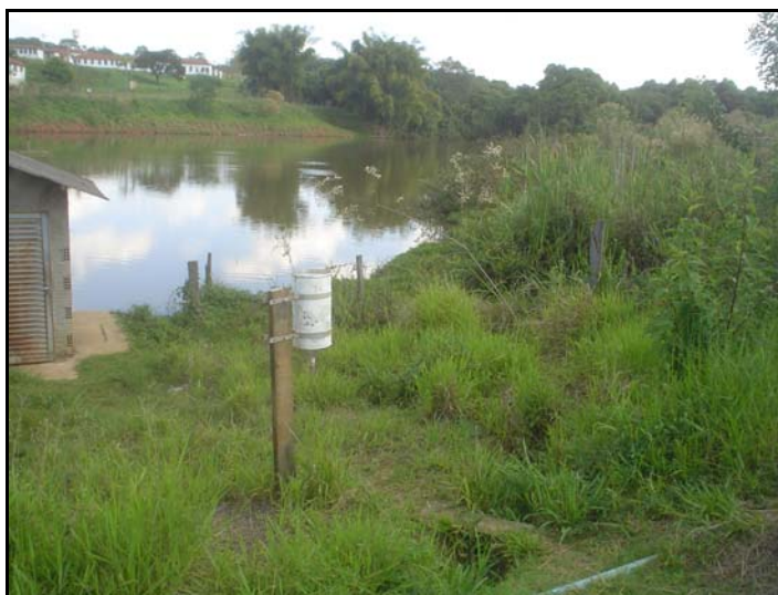
Figura 4.16 – Pluviômetro instalado próximo à área experimental (Fonte: AUTOR, 2008)
