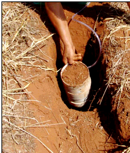
Figura 4.13 - Instalação de um coletor no experimento. Colégio Agrícola, Franca/SP (Fonte: AUTOR, 2007)
