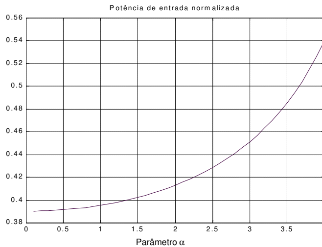
Figura 2. 21 - Potência de entrada normalizada em relação a V_p^2/\omega L
