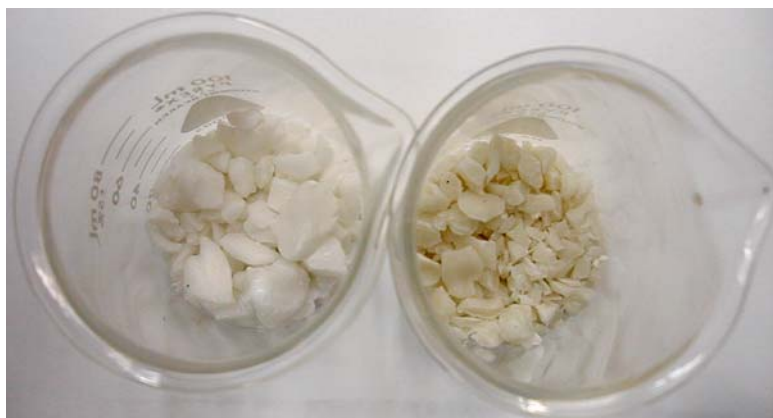
Figura 81: Fotografia das amostras da blenda PP/PS (85:15) sem compatibilizante, à direita, e com 0,03 phr de compatibilizante, à esquerda. (Foto por Marco-Aurelio De Paoli, Camera Digital EPSON PC 750Z, resolução 1280x960 pixels)
