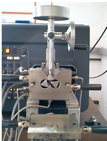
Figura 35: Fotografia da câmara de processamento aberta do reômetro de torque da HAAKE.
