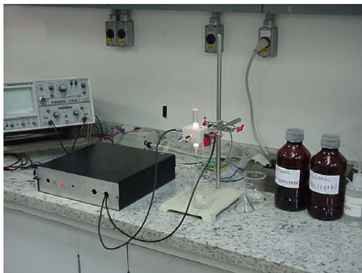
Figura 6.10: Imagem geral do fotômetro construído baseado no modelo de cela da Figura 5.8.
