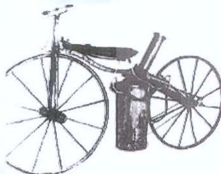
Figura 3: Bicicleta montada e equipada com motor a vapor por Silver Roper em 1869
