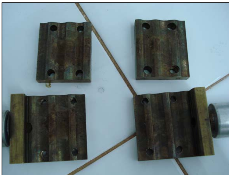
Figura 7- Sistema de ancoragem (presilhas) utilizadas nos ensaios biomecânicos.
