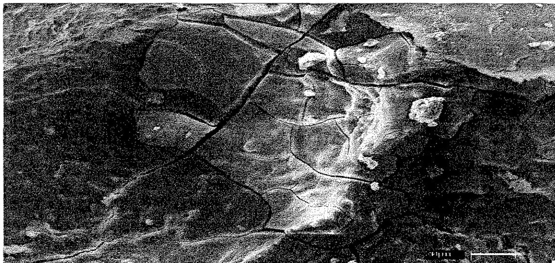
Amostra contendo cimento tipo C-II e 40% de adição de cinza volante
