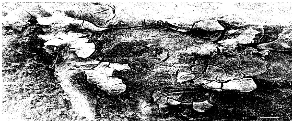
Amostra contendo cimento tipo C-II e 40% de adição de cinza volante
