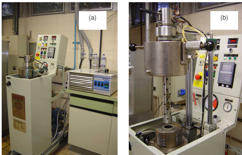
Figura 2. Equipamento de Alta Pressão Hidrostática. (a) vista frontal (b) detalhe do suporte de amostra.
