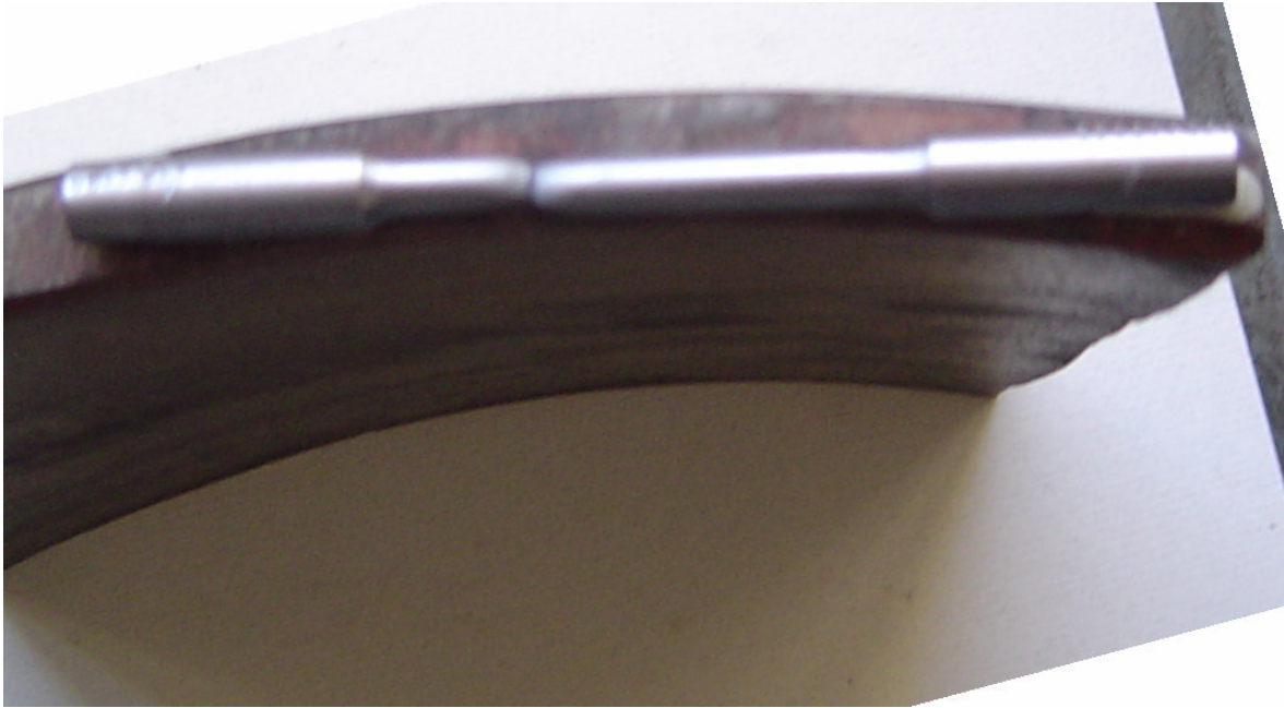
Figura 5.3. Detalhe da região e orientação no tubo de onde foram retirados os corpos-de-prova transversais.
