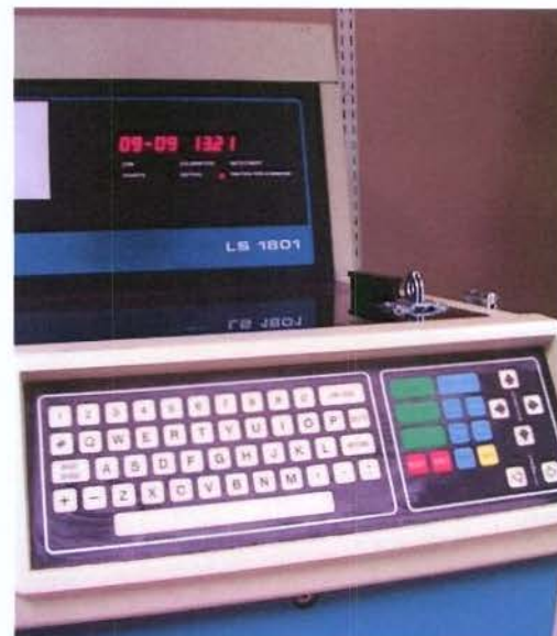
Figura 18. Cintilador (Scintillation Counter Beckman LS 1801, Fullerton, CA, USA) utilizado para contagem do número de células aderidas nos discos.
