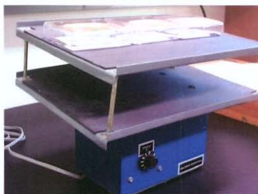
Figura 14. Membranas incubadas com anticorpos apropriados durante 1 hora em mesa agitadora (Rocker - Reliable Scientific ( USA.)
