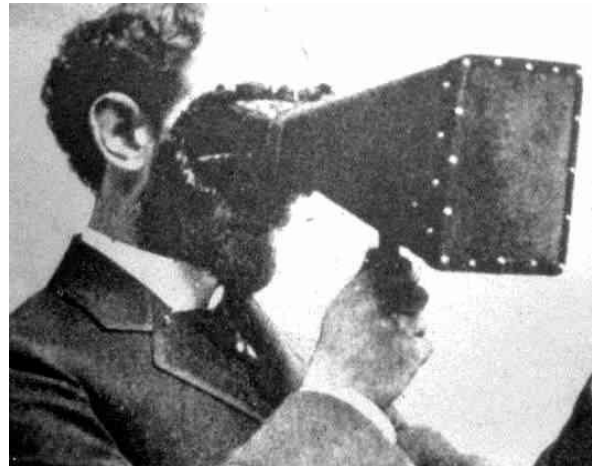
Fig. 3.2: A) Sistema fluoroscópico publicado em um livro em 1896; B) Sistema fluoroscópico portátil, desenvolvido também em 1896 (Sabbatini, 2003).
