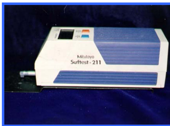
FIGURA 11 - Rugosímetro utilizado na leitura da rugosidade superficial in vitro
