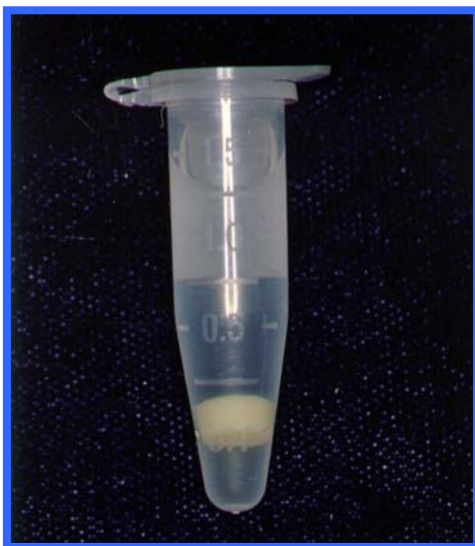
FIGURA 9 - Corpo de prova colocado em solução de NaOH 1,0M, para extração da placa bacteriana
