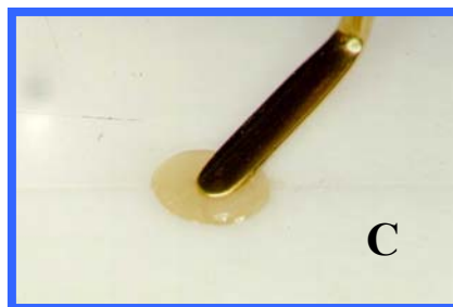
FIGURA 4 - Preparo dos corpos de prova em matriz de teflon. A) inserção do material com seringa fornecida pelo fabricante; B) acomodação do material, com uma espátula para resina composta nº5; C) acomodação da segunda camada.
