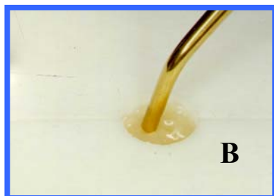
FIGURA 4 - Preparo dos corpos de prova em matriz de teflon. A) inserção do material com seringa fornecida pelo fabricante; B) acomodação do material, com uma espátula para resina composta nº5; C) acomodação da segunda camada.
