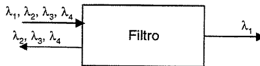
Figura 3.6: Filtro óptico simples (rejeição por reflexão)
