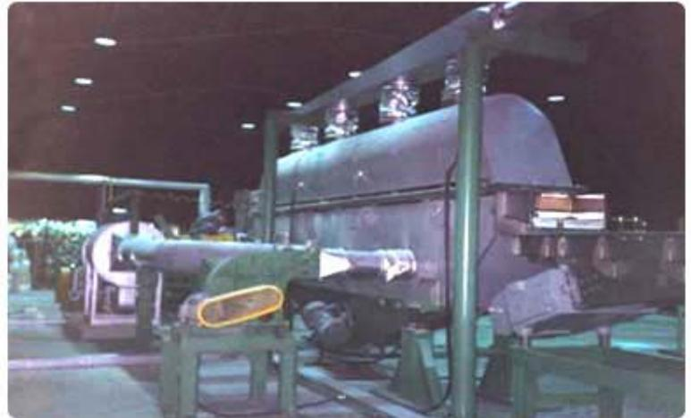
**Figura 3.4-51: Secadores vibro-fluidizados industriais.**
