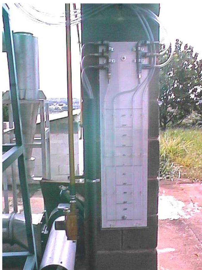
**Figura 4.3-3: Manômetros em U para perda de carga e tubo de Pitot.**
