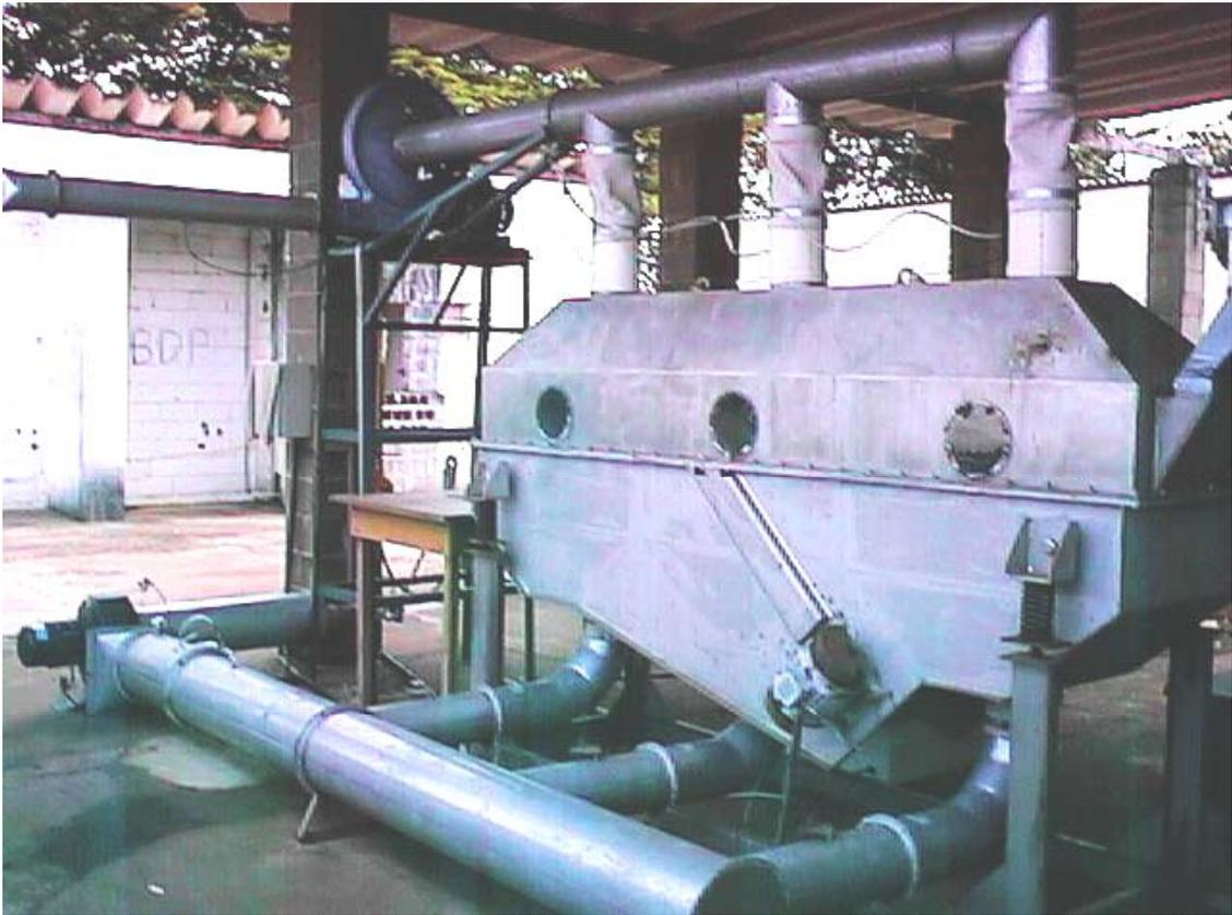
***Figura 4.2-8: Secador vibro-fluidizado completo com as janelas de inspeção.***
