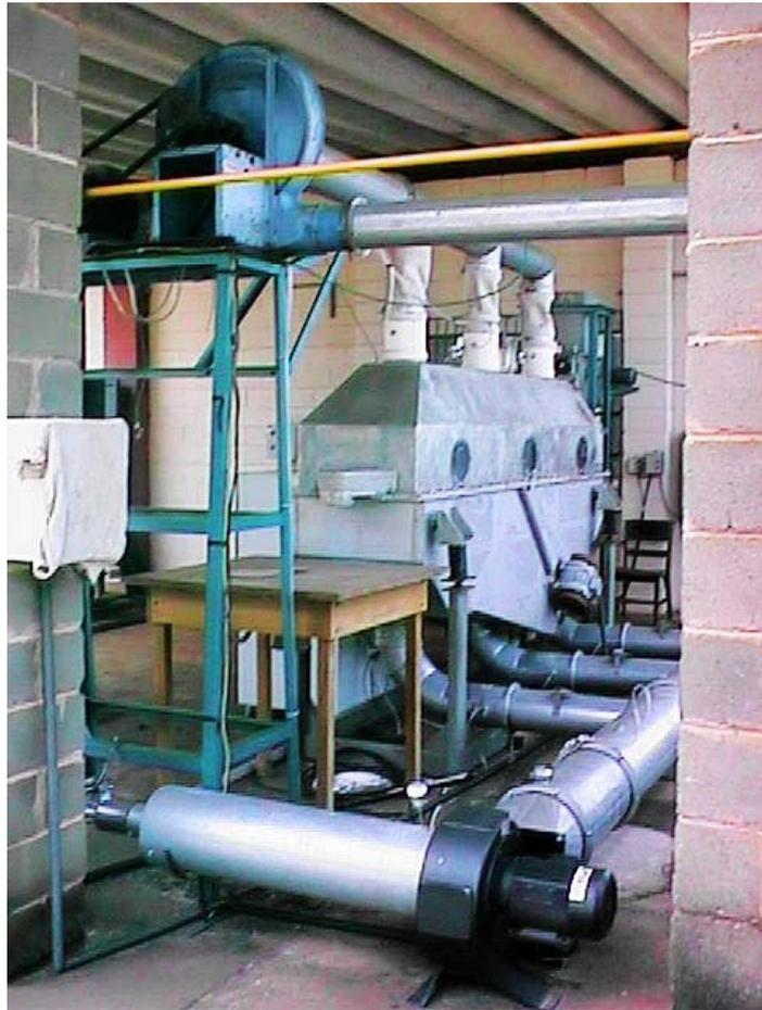
**Figura 4.2-9: Vista do secador montado.**
