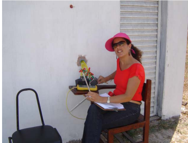
Figura 3.10 Saída dos termopares, seletores, termômetro digital e termômetro de vidro.
