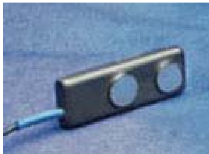
Figura 16: Eletrodos ativos da marca Biopac (Biopac System, Inc., Santa Barbara, CA, USA), modelo TSD-150.
