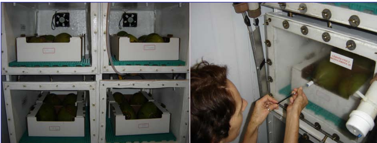
Figura 5. Microcâmaras utilizadas na análise da concentração de O_2 , CO_2 e etileno na atmosfera durante o armazenamento dos cocos. À esquerda, frutos dispostos nas microcâmaras no início do armazenamento; à direita, amostragem da atmosfera.
