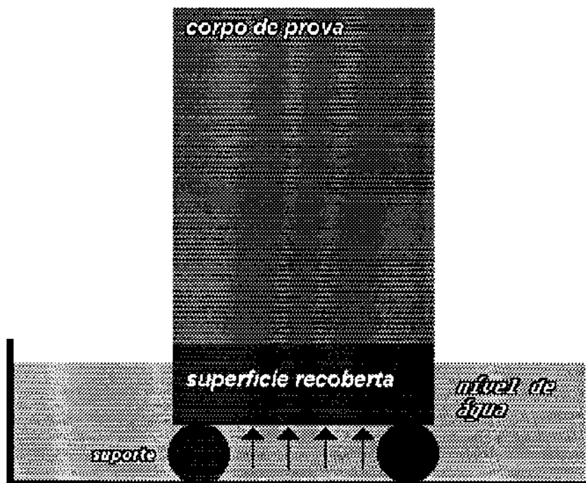
Figura 12- Diagrama esquemático dos ensaios de sortividade
