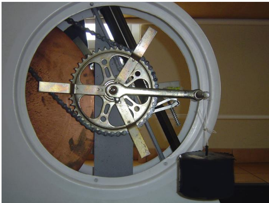
Figura 4.4 – Fotografia da aplicação do momento de força que gera um torque conhecido à estrutura.
