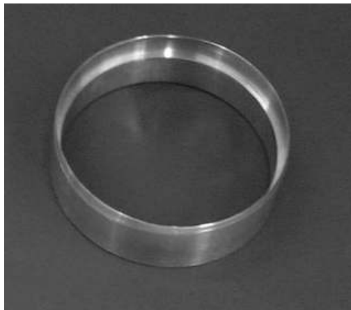
Figura 4. Cortador utilizado para obter as amostras em formato circular
