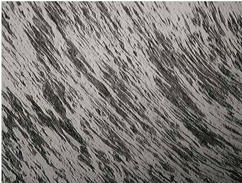
Figura 34: Micrografia da estrutura do tubo estampado sem aquecimento posterior na região próxima a dobra de conformação da ogiva – ferrita e perlita encruada. Aumento: 500x / Ataque: Nital 3%
