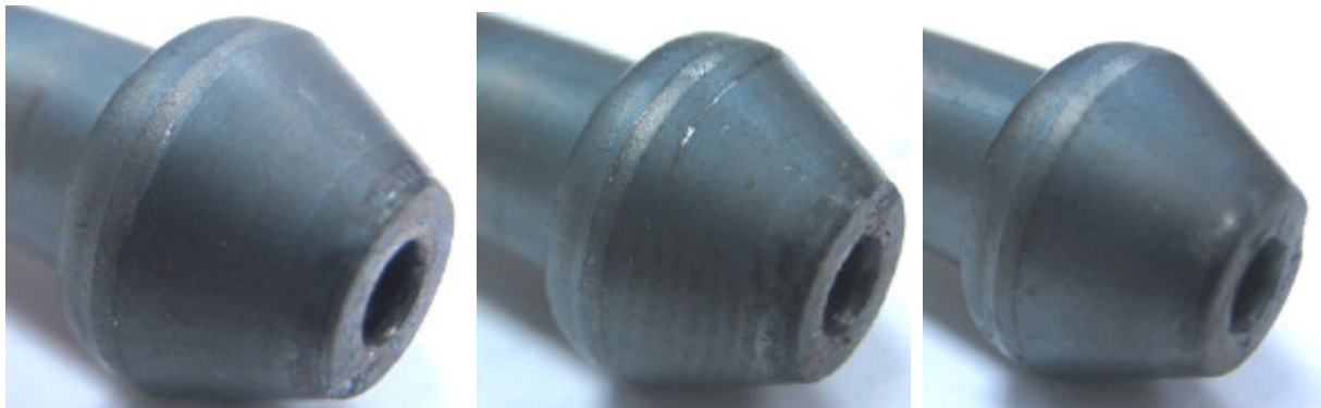
Figura 54: Tubos sem camada zincada bicromatizada aquecidos a 350, 400 e 450 °C respectivamente.
