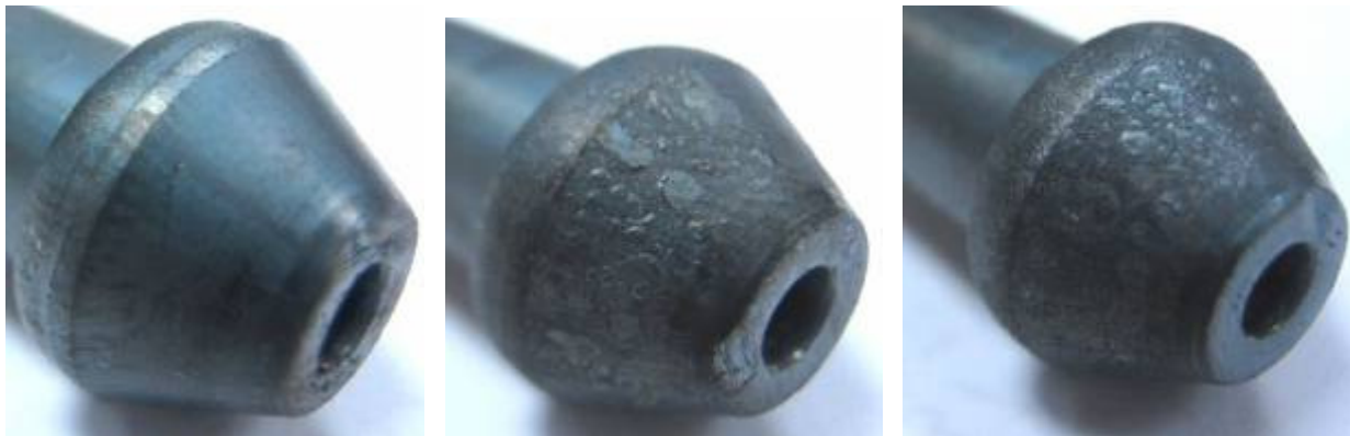
Figura 55: Tubos sem a camada zincada e bicromatizada aquecidos a 500, 550 e 600°C
