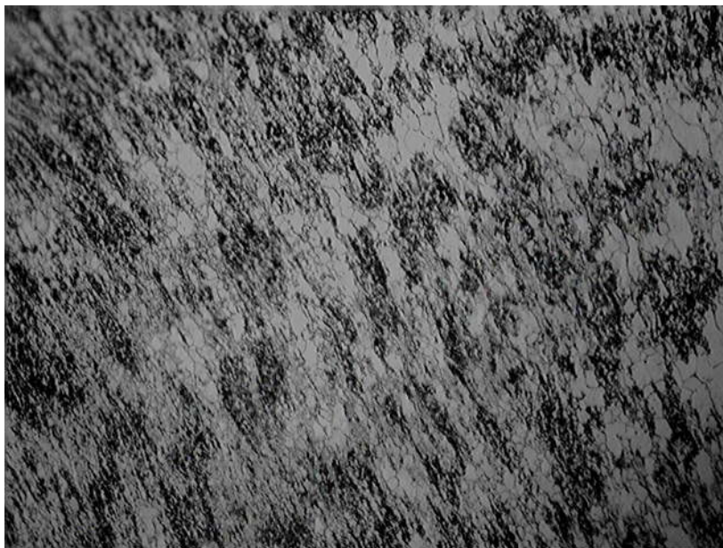
Figura 38: Microestrutura do núcleo do tubo aquecido a 350°C na região próxima à dobra de conformação, reagente: Nital 3%, ampliação: 500X.
