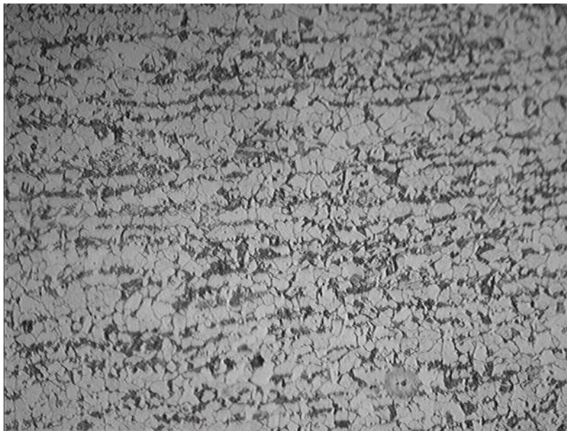
Figura 47: Micrografia da estrutura do núcleo do tubo 600° na região de localização da medição de dureza da ogiva conforme desenho - ferrita e perlita. Aumento: 500x / Ataque: Nital 3%
