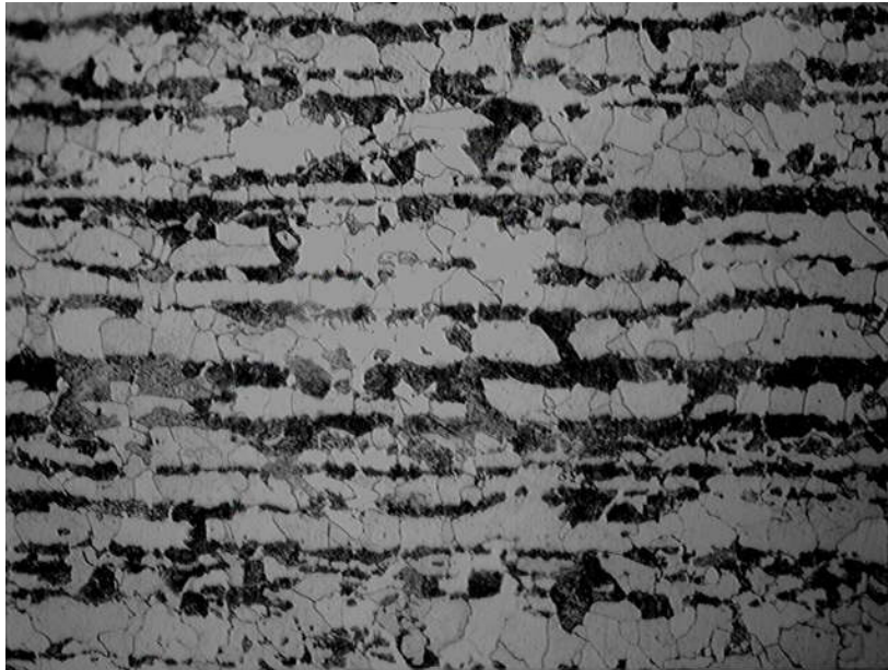
Figura 37: Microestrutura do núcleo do tubo aquecido a 350°C na região a 2mm do topo da ogiva, reagente: Nital 3%, ampliação: 500X.
