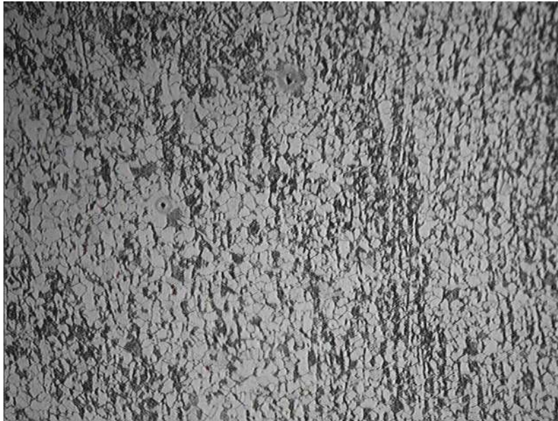
Figura 46: Microestrutura do núcleo do tubo aquecido a 550°C na região próxima à dobra de conformação, reagente: Nital 3%, ampliação: 500X.
