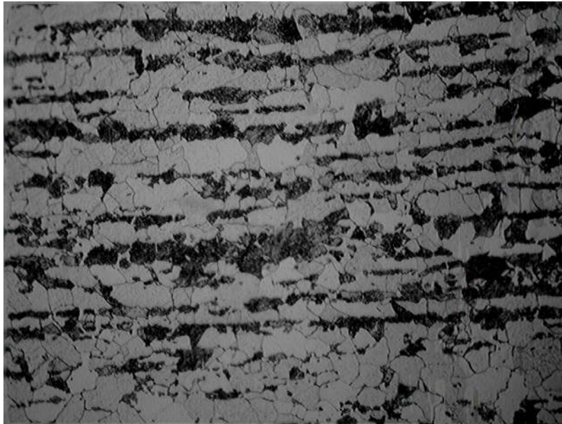
Figura 35: Microestrutura do núcleo do tubo aquecido a 300°C na região a 2mm do topo da ogiva, reagente: Nital 3%, ampliação: 500X
