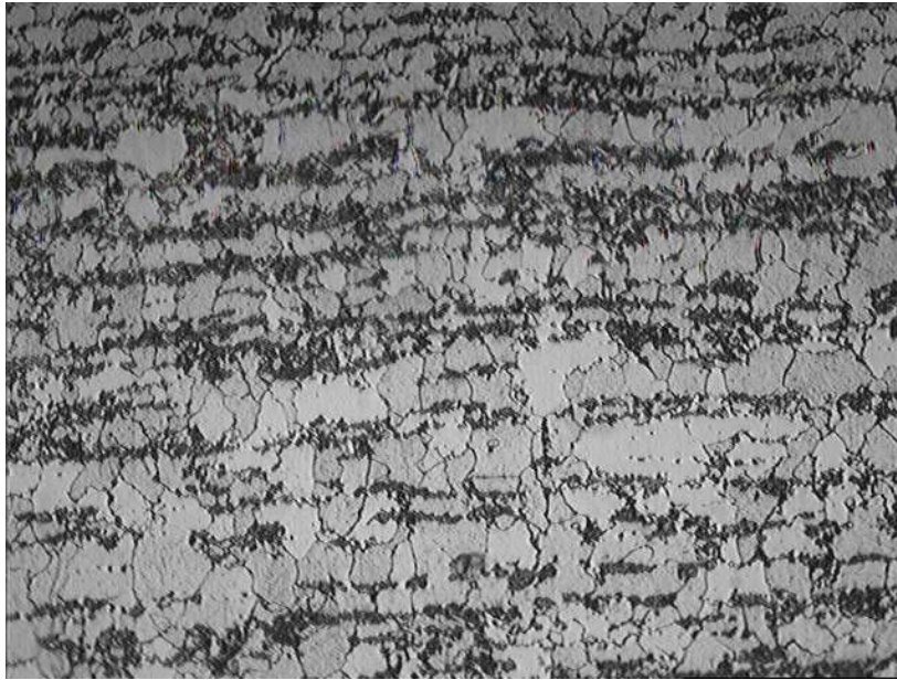
Figura 39: Microestrutura do núcleo do tubo aquecido a 400°C na região a 2mm do topo da ogiva, reagente: Nital 3%, ampliação: 500X.
