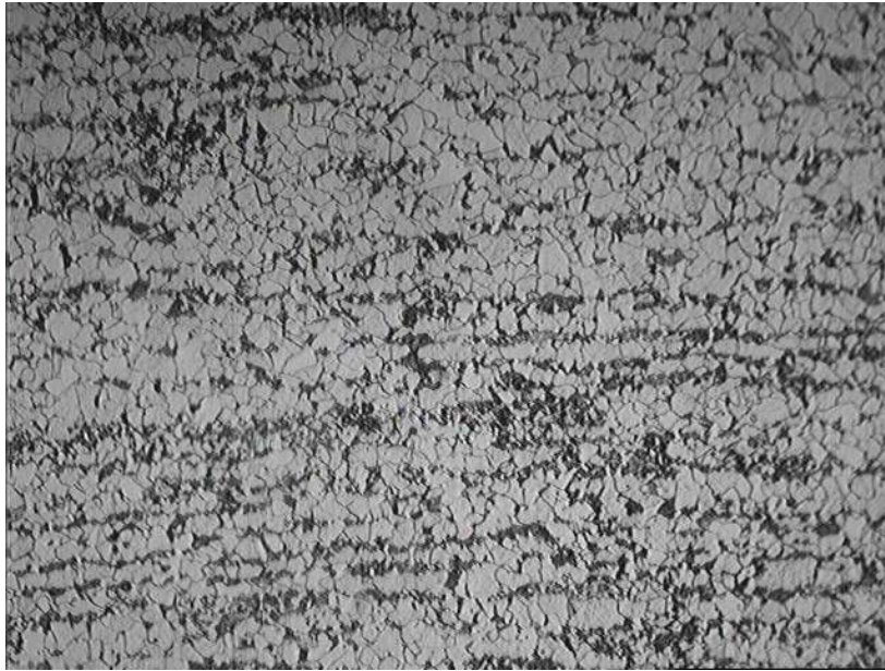
Figura 43: Microestrutura do núcleo do tubo aquecido a 500°C na região a 2mm do topo da ogiva, reagente: Nital 3%, ampliação: 500X.
