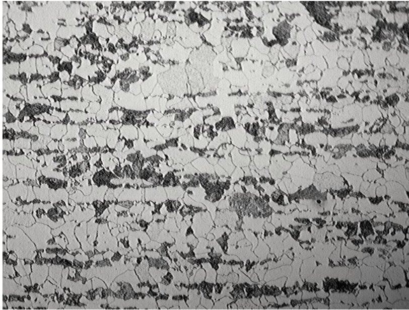
Figura 33: Microestrutura do núcleo do tubo estampado sem aquecimento posterior. Região de localização da medição de dureza da ogiva conforme desenho - ferrita e perlita. Aumento: 500x / Ataque: Nital 3%
