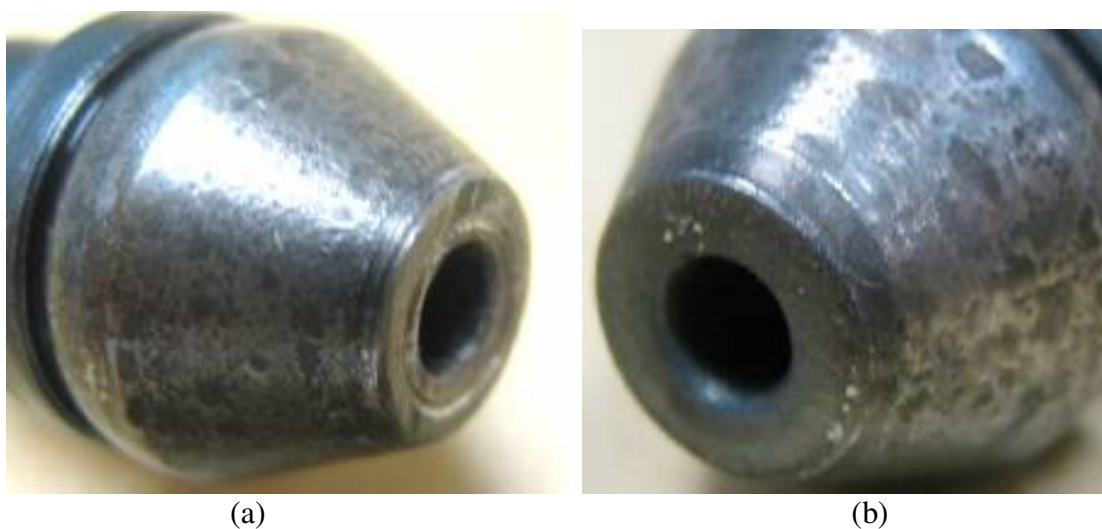
Figura 59: Visualização de área de acomodação com contra-peça de tubos aquecidos a 450°C (a) e 500°C (b).
