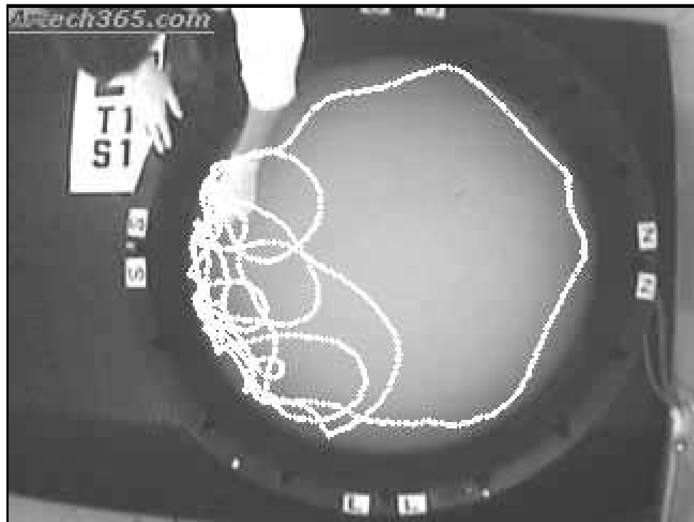
Figura 4.4: Resultados do rastreamento para o experimento do labirinto aquático de Morris utilizando o sistema proposto.
