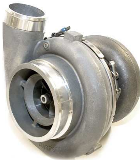
Figura 1-5 – Exemplo de máquina rotativa: Turbocompressor para automóveis. Fonte: Saab
