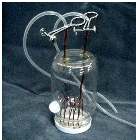
Figura 21 – Célula de adsorção desenvolvida
