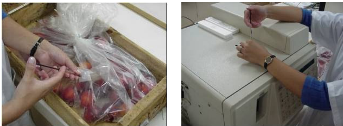
Figura 11 – Medição da composição gasosa.
