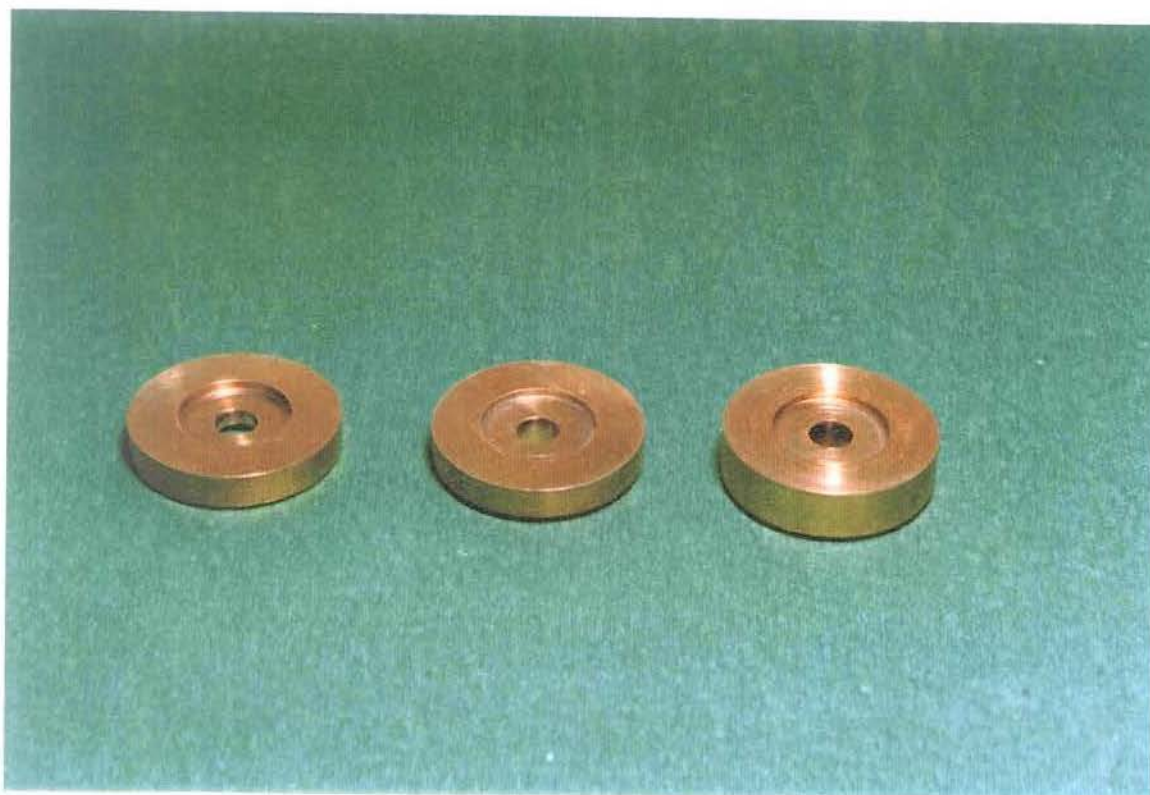
Figura 2 – Espaçadores usados para manter a ponta ativa do fotopolimerizador à diferentes distâncias da superfície do corpo-de-prova.
