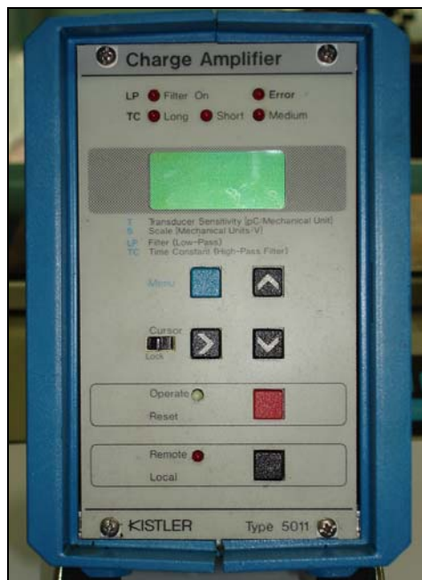
Figura 3.3 Amplificador piezelétrico marca Kistler modelo 5011
