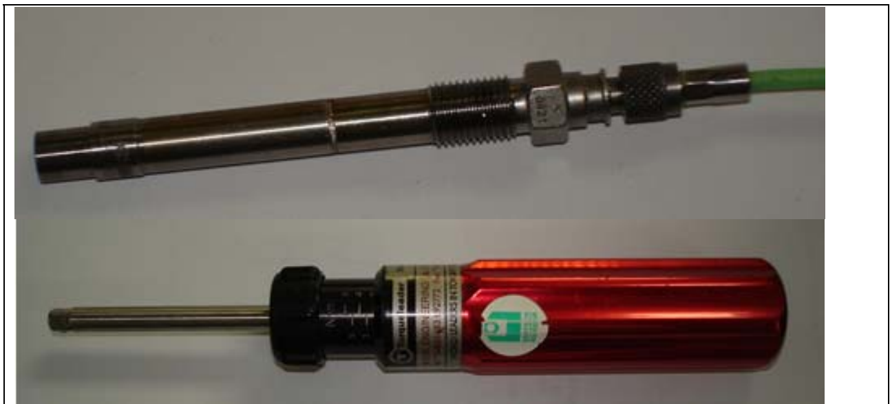
Figura 3.2 - Transdutor de pressão piezelétrico Kistler 6001 e torquímetro
