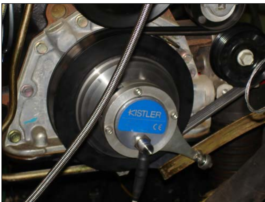
Figura 3.5 – “Encoder” instalado no motor
