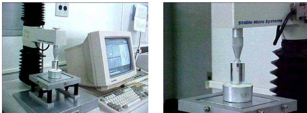
Figura 3.7 Equipamento utilizado para a análise de perfil de textura com amostra de requeijão sendo analisada.
