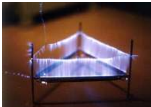
Figura 3.1: Fenômeno do efeito corona.
