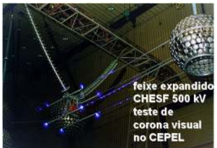
espaçadores para feixe expandido CHESF 500 kV ensaios no CEPEL
