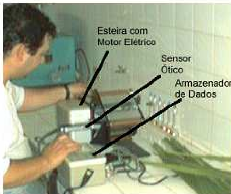
Figura 1. Aparelho LI-COR/LI-3000A para medida da Área Foliar, destacando seus três componentes principais.
