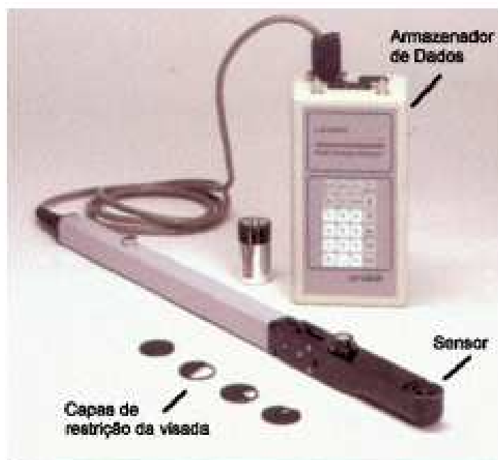
Figura 1. Aparelho LI-COR/LI-3000A para medida da Área Foliar, destacando seus três componentes principais.
