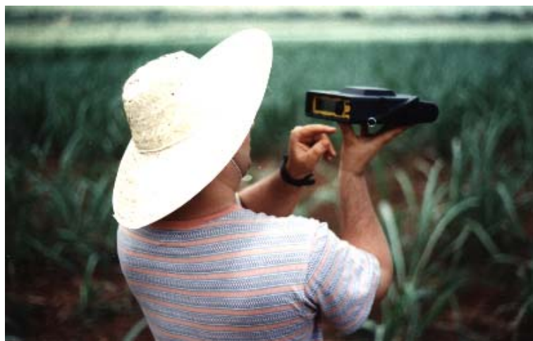
Figura 1. Determinação das coordenadas geográficas de uma das parcelas pertencentes à área de trabalho, usando o aparelho de GPS modelo Pathfinder Basic™ Receivers, fabricado pela Trimble Navigation.
