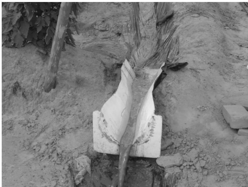
Figura 10. Calha WSC flume B no final do sulco de distribuição.
