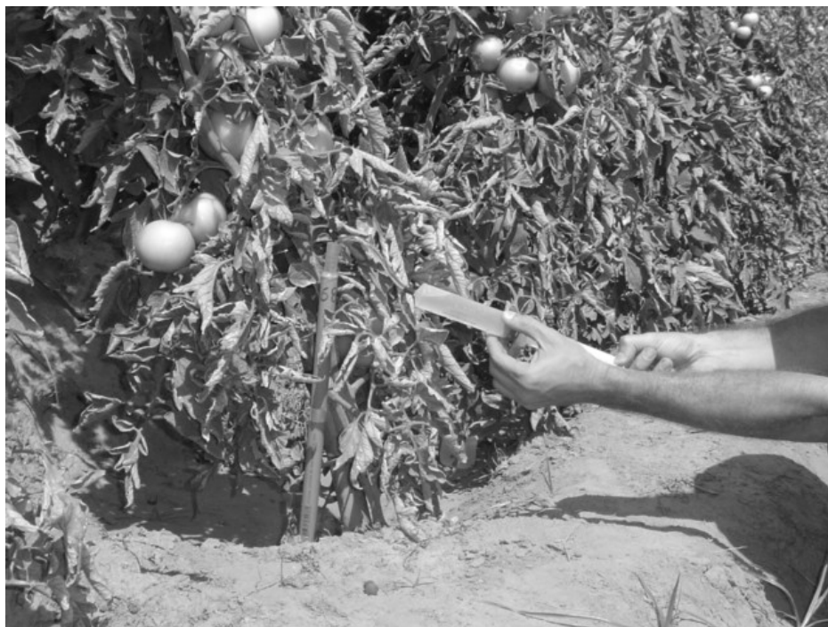
Figura 7. Extração da solução do solo para determinação de CE.
