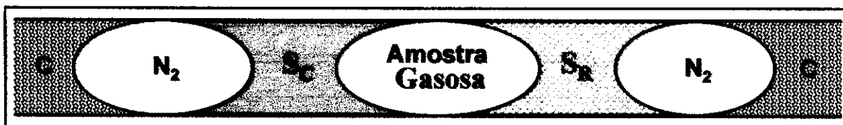
Figura III.7. Disposição da amostra gasosa no Sistema em Fluxo Bissegmentado
