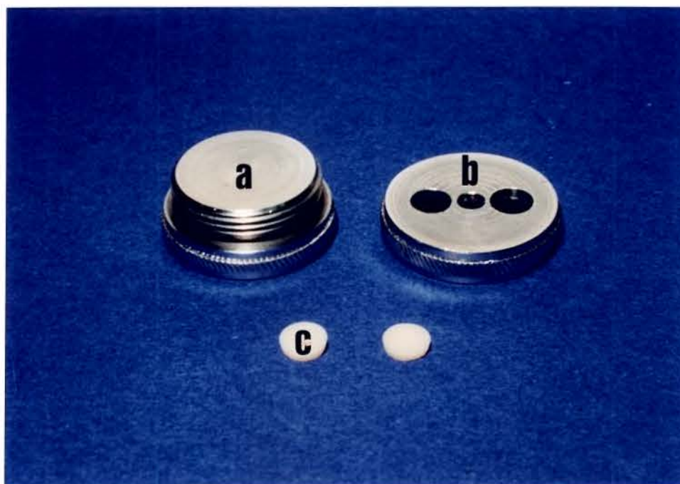
FIGURA 1- Parte inferior (a) e superior (b) da matriz metálica utilizada para a confecção das amostras de polímero de vidro (c).
