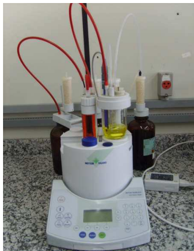
Figura 3.3.2.1: Karl Fischer usado na determinação das quantidade de água.
