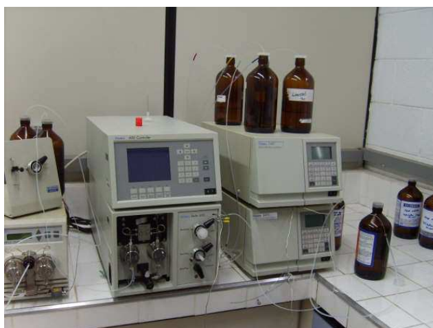
Figura 3.3.3.1: Cromatógrafo usado durante as análises do ácido acrílico das fases orgânica e aquosa.
