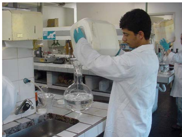
FIGURA 4.3 Esgotamento da embalagem, conforme ABNT (1997a)
