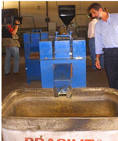
FIGURA 3.11 Formação de pellets no processo de reciclagem de embalagens de agrotóxico
