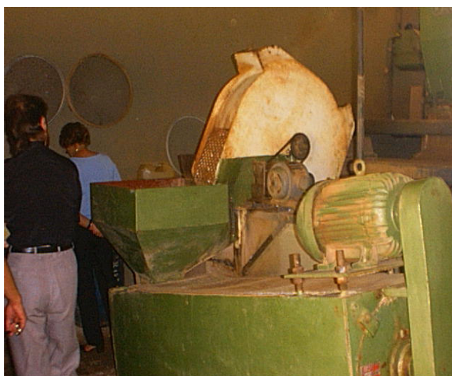
FIGURA 3.9 Triturador de embalagens de agrotóxico na recicladora
